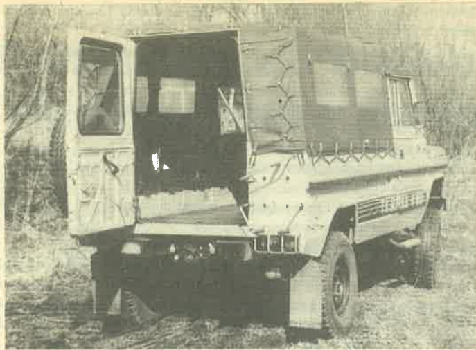
Rys 5. Rozwiązanie konstrukcyjne tylnych drzwi ułatwia wsiadanie bądź załadunek (fot. W. Karwas)
