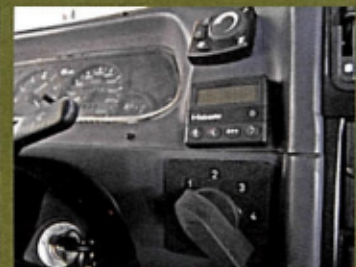
▲ Przełącznik lamp Notek i sterownik dodatkowych ogrzewań
